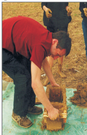
A, B, C, D. Przygotowywanie gliny do wytwarzania cegieł. Fot. R. Barek, 2002 - 2003
