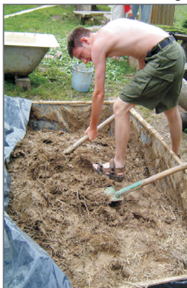
A, B, C, D. Przygotowywanie gliny do wytwarzania cegieł. Fot. R. Barek, 2002 - 2003
